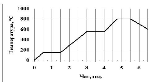
Рис. 6. Режими прожарювання гіпсокремнеземистих формувальних сумішей
